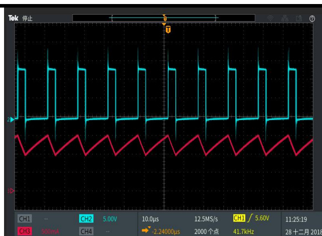
SW 脚与电感电流工作波形
